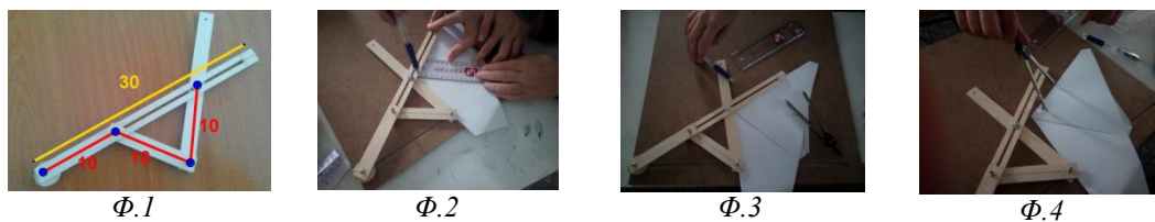
Σχήμα 9: Ξύλινο αντίγραφο τριχοτόμου Pascal
