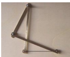
Σχήμα 8: Αναπαραστάσεις μοντέλου ελλειψογράφου του Frans van Schooten
